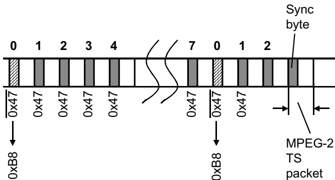
Fig. 14.7. Sync byte inversion
